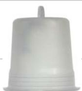
Le bouchon PEHD avec attache filin assure l'obturation des alvéoles à l'arrivée d'une chambre, avant et après la réception des conduites, afin d'éviter les pénétrations d'eau, de boue...
