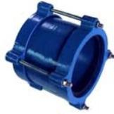
Les joints GIBAULT servent à raccorder en cas de casse deux bouts mâle-mâle d'un même tuyau. La gamme GT à joints profilés permet le raccordement de tuyaux d'un diamètre extérieur compris dans une plage d'utilisation.
